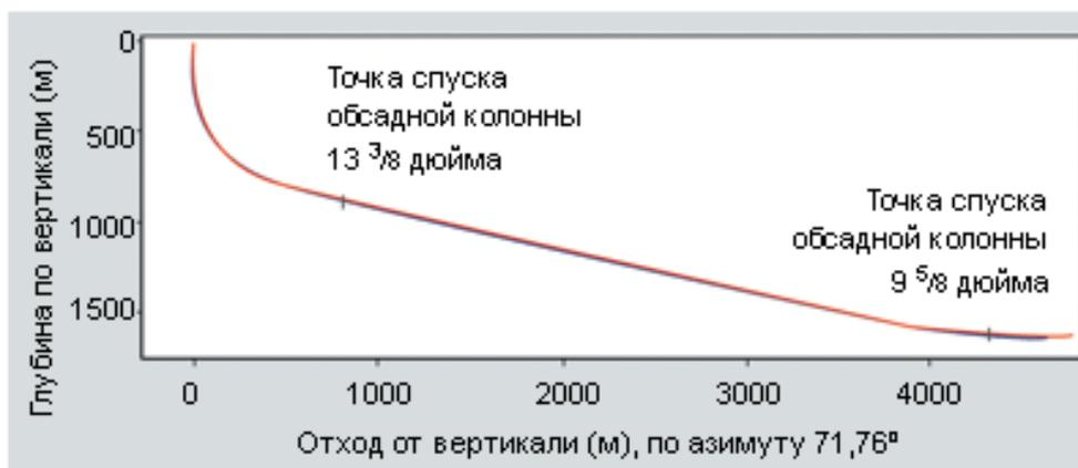
Рисунок 2.3 – профиль скважины 216 пробуренной с использованием системы PowerDriveXtra
